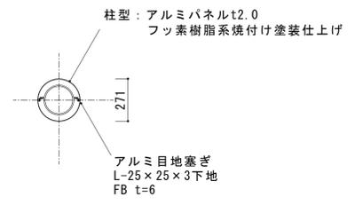
鉄骨柱詳細図 S=1/20
